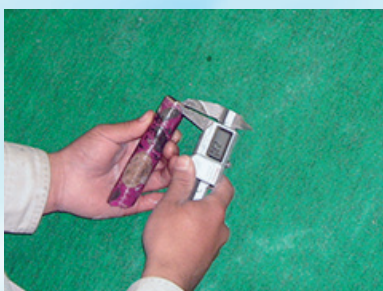
中性化深さ測定状況
